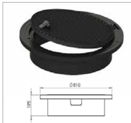
403428 Varitank dekselset, Rond klasse D gietijzer. Het dekselset is geheel van gietijzer en voorziet in een ronde kraag met een scharnierend deksel. De ronde kraag valt telescopisch over de Varitank schacht en is perfect geschikt om in een asfalt laag te verwerken, geheel is klasse D (zwaar verkeer) belastbaar.
